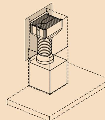
\* L'installation de ce module requiert un espace de 25 cm entre le haut du fût et le plafond afin de pouvoir changer le filtre une fois par an.
